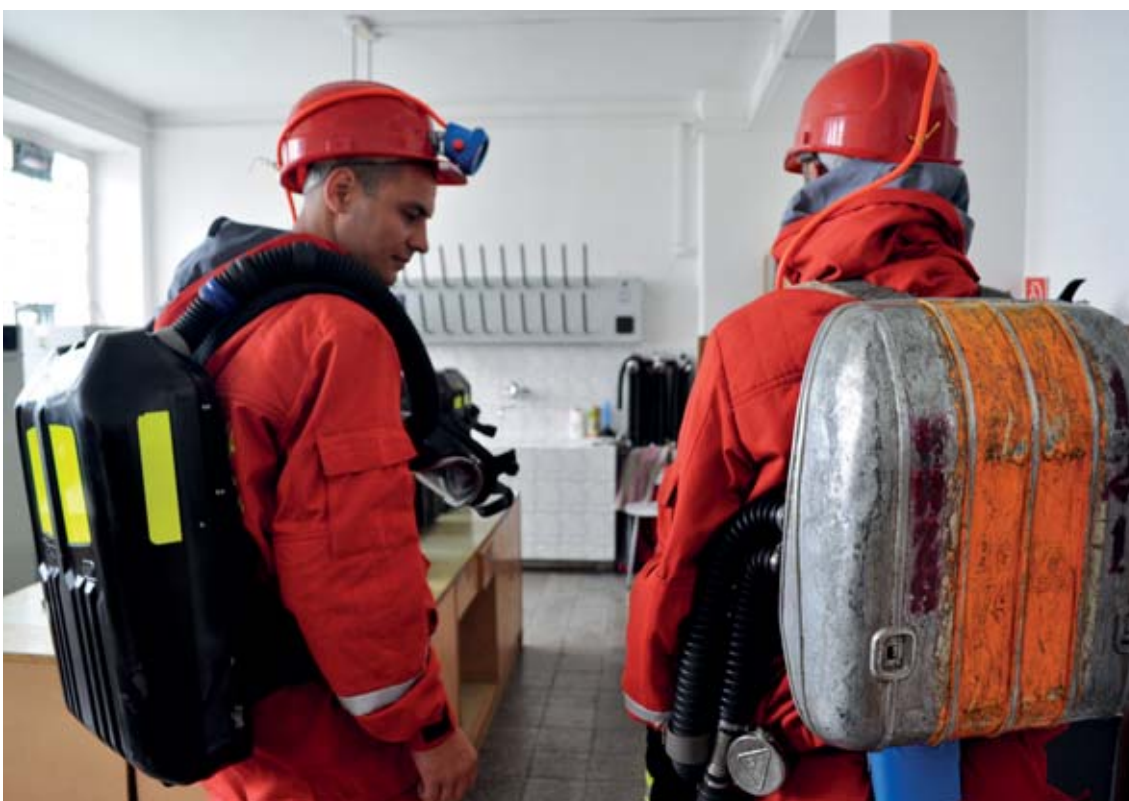
Generačná výmena dýchacích prístrojov banských záchranárov. Staré BG 174 Dräger nahradili nové BG-4 PSS.
