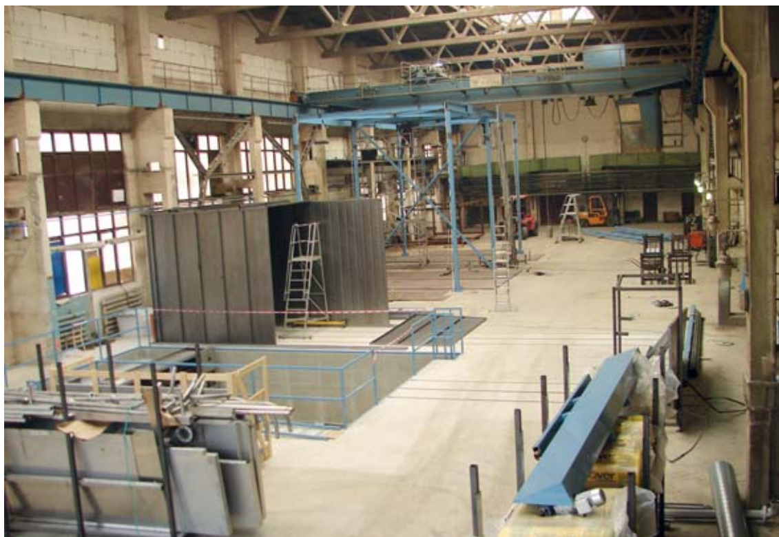
Nová lakovacia linka v strojárskom závode BME Nováky. Rekonštrukciou lakovacej linky a zavedením modernej technológie predúpravy výrobkov pred nanášaním náterových látok a procesom nanášania náterových látok sa podstatne zvýšila kvalita povrchu výrobkov a zároveň sa vytvorilo priaznivé pracovné prostredie pre pracovníkov vykonávajúcich tieto práce.
