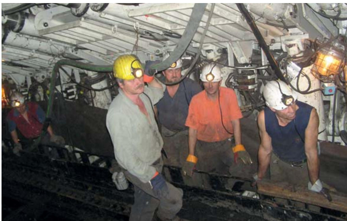
Ťažbu na novej ťažobnej kapacite rozbiehal stenársky kolektív Ivana Mišáka. 300-metrový stenový porub bol vybavený 57 sekciami banskej mechanizovanej výstuže BMV1Mi, dobývacím kombajnom KGS 324 a novým stenovým dopravníkom HDF 255/785, špeciálne vyrobeným pre tento porub v strojárskom závode Banská mechanizácia a elektrifikácia Nováky.
